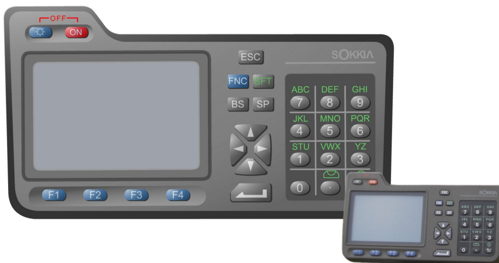
Figura 5 –Painel virtual e real da estação total Sokkia SET2100.
